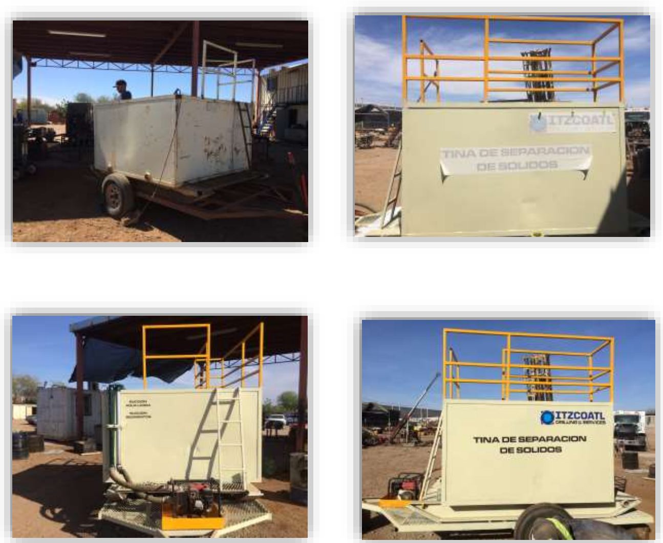
Figura 21. Diferentes etapas de construcción del sistema de recirculación de agua.
