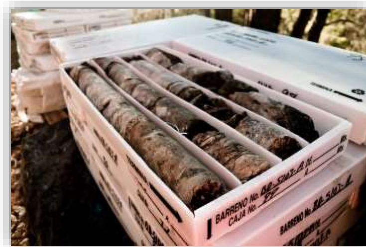
Figura 4. Núcleo de roca extraído por perforación a diamante. Fuente: Itzcoatl Drilling and Services S.A. de C.V.
