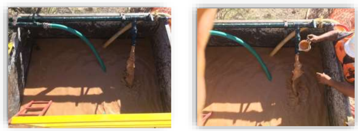
Figura 25. Alimentación de tina de remoción de sólidos
